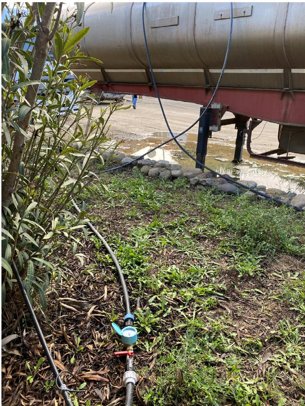
**Fotografia 5:** *Piezometro 1 – installazione flussometro all’ingresso della cisterna (deposito temporaneo P1 e P2)*
